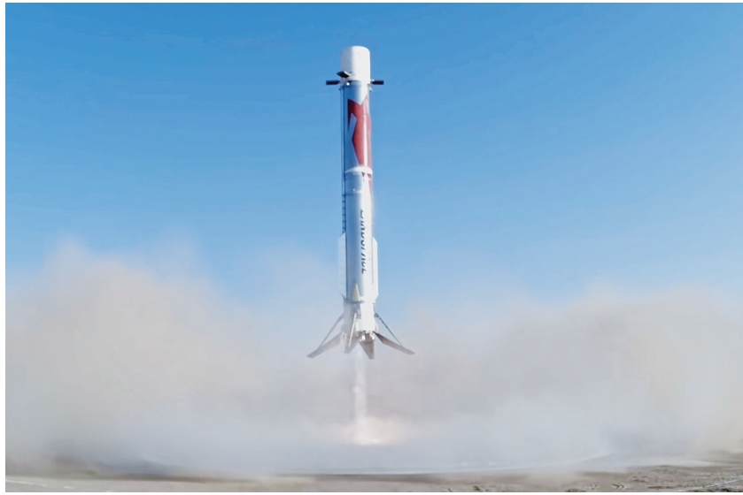
8月19日，视频截图显示朱雀三号遥二运载火箭一级级在着陆过程中展开着陆支腿，正在着陆。 新华社发
